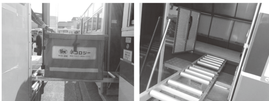
図4-3 宅急便から路線バスへの積替えの様子 注) 左側写真は荷物の積み替え風景，右側写真はトラックからバスへの積替え台 出典：2017年11月西都バスセンターで著者撮影。
